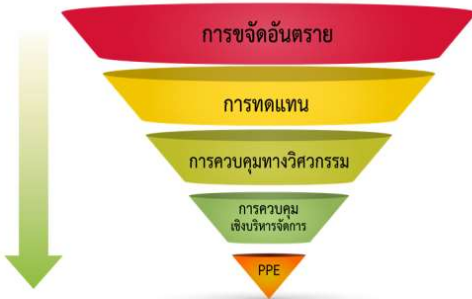
ภาพที่ 1 ลำดับของมาตรการควบคุมป้องกันการตกจากที่สูง ตามมาตรฐาน มปอ. 402 : 2561
