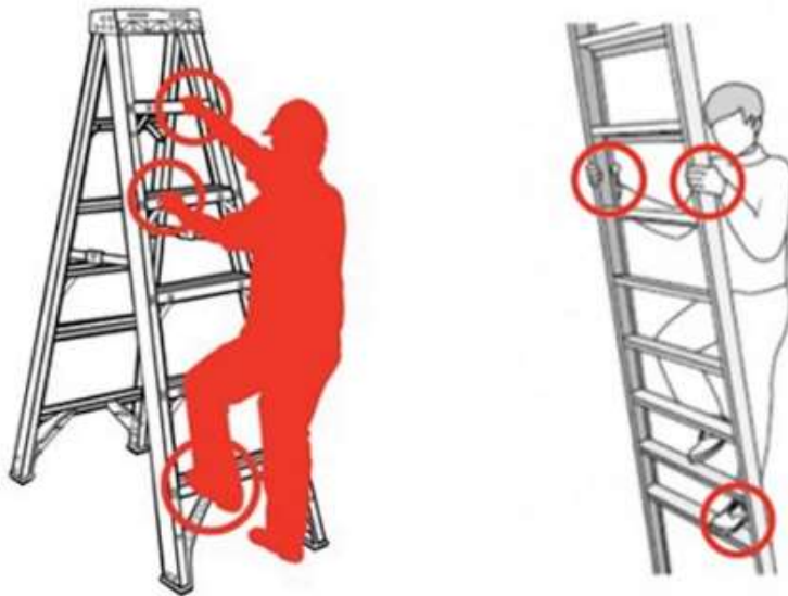
ภาพที่ 6 ตัวอย่างการสัมผัสกับบันไดอย่างน้อย 3 จุด (3 Points of Contact)
